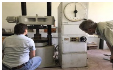
Рис. 4. Встановлення циліндру з наважкою щебіня з хвостів СМС під прес
