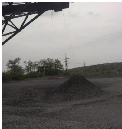
Рис. 1. Хвости СМС у відкритому конусному терміналі технологічної лінії грохочення ПАТ «ІнгЗК»
