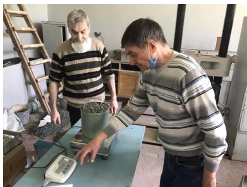
Рис.3. Зважування вимірювального циліндру зі щебенем на настільних електричних вагах
