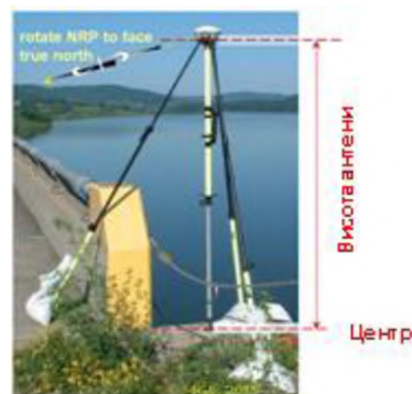
Рис. 4. Визначення висоти антени GPS-приймача
