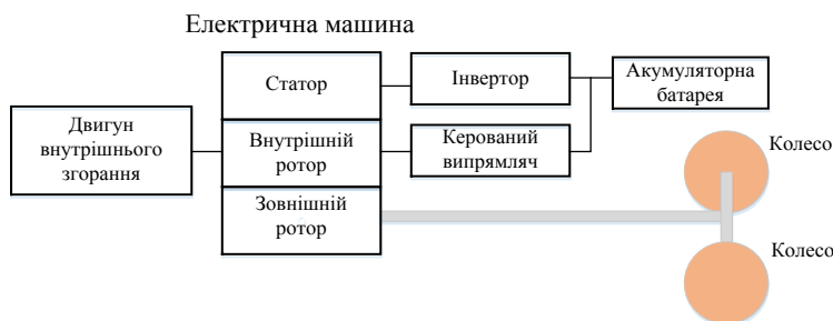
Рис. 3. Структура приводу гібридного транспортного засобу з використанням однієї електричної машини
