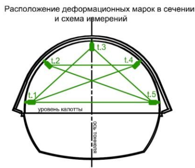
Рис. 3. Расположение деформационных марок (реперов) в сечении калотты
