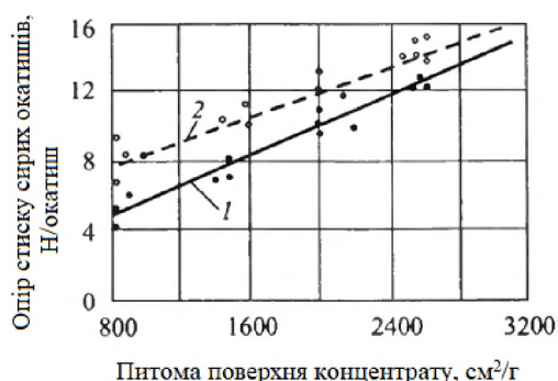
Рис. 1. Залежність міцності сирих окатишів від величини питомої поверхні шихти: 1 – неофлосовані; 2 – офлосовані до основності 0,8–1,0
