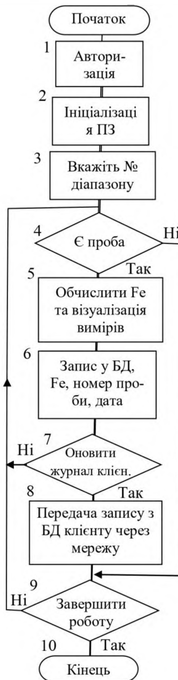
Рис.2. Блок схема алгоритму роботи ГПС-1
