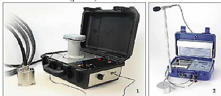
Рис. 1. Обладнання для реєстрації сейсмоколивань ґрунту та тиску на фронті ударної повітряної хвилі: 1 - сейсмостанція ZET 048-E; 2 - сейсмограф BlastMate III
