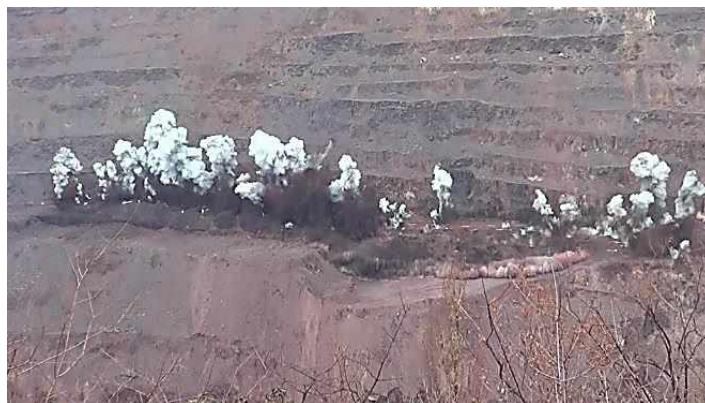
Рис. 4. Експериментальний вибух на блоці №71 гор. -46/-58 м
