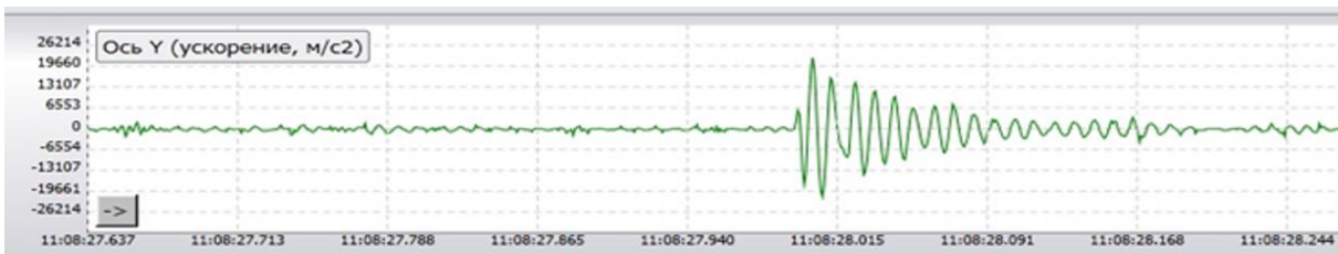
Рис. 6. Сигнал тріщини на відстані 100 м. A_y = 22000 од.ащп, T = 250 мс
