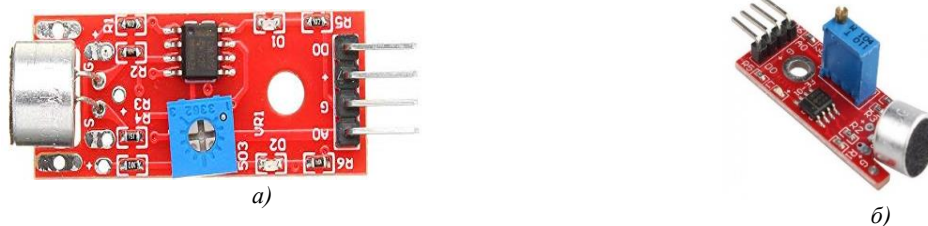
Рис.2. Зовнішній вигляд датчика KY-037: а - вигляд датчика KY-037 зверху; б - вигляд датчику KY-037 з боку
