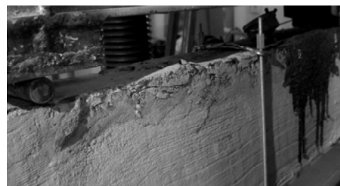
Рис. 7. Характерні пошкодження Б-1(ліворуч) та Б-2(праворуч)
