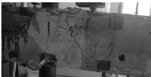
Рис. 7. Характерні пошкодження Б-1(ліворуч) та Б-2(праворуч)
