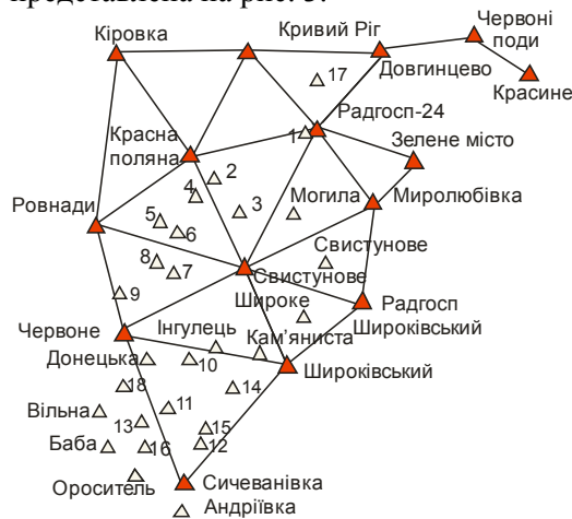
Рис. 3. Фрагмент мережі триангуляції 1-4 класів південної частини Криворізького регіону у 1960 р.: 1 - Гданцевка; 2 - Войкове; 3 - Новоселівка; 4 - Високий; 5 - Рахмановка; 6 - Латовка; 7 - Артель; 8 - Стародобровільське; 9-Земная; 10-Виноградне; 11 - Надія; 12 - Радичеев; 13-Микола-Козельський; 14-Глиняний; 15 - Радичеев 1; 16 - Електролінія; 17 - Черногірка; 18 - Руднична
