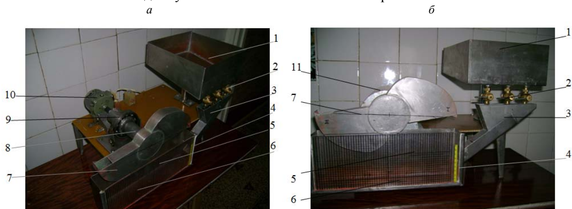
Рис. 2. Физическая модель улиткового питателя без кожуха а и в плане относительно улитки б : 1 - емкость с жидкостью; 2 - средства регулирования расхода жидкости; 3 - песковый желоб; 4 - приемное устройство; 5 - прозрачная стенка со шкалой; 6 - жидкость; 7 - улитка с двумя захватными элементами; 8 - ось вращения улитки; 9 - шариковый подшипник; 10 - электродвигатель; 11 - кожух
