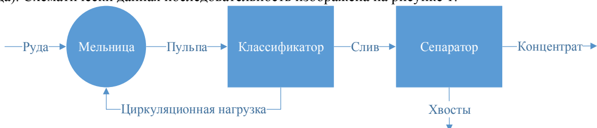
Рис. 1. Схема преобразования сырья на этапах измельчения и обогащения железной руды
