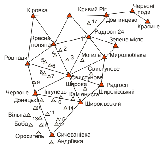
Рис. 3. Фрагмент мережі триангуляції 1-4 класів південної частини Криворізького регіону у 1960 р.: 1 - Гданцевка; 2 - Войкове; 3 - Новоселівка; 4 - Високий; 5 - Рахмановка; 6-Латовка; 7-Артель; 8-Стародобровільське; 9-Земная; 10-Виноградне; 11-Надія; 12-Радичев; 13-Микола-Козельськ; 14-Глиняний; 15-Радичев1; 16-Електролінія; 17-Чорногірка; 18-Руднична
