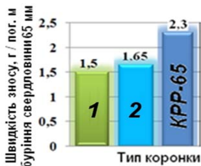
Рис. 7. Результаты сравнительных испытаний по породам крепостью f=10
