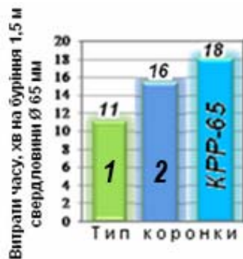
Рис. 5. Результаты сравнительных испытаний по породам крепостью f=10
