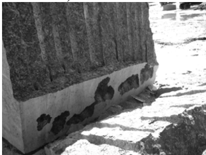
Рис. 1. Результат неконтрольованої швидкості розповсюдження магістральної тріщини
