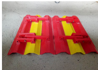
Рис.3. Моделі конструкцій фундаменту з пластику у зібраному вигляді: а – модель прототипної конструкції складчастого фундаменту; б – модель оптимальної конструкції складчастого фундаменту
