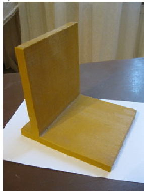
Рис. 4. Фізичні моделі підпорних стін: а – кутникова підпірна стіна; б – підпірна стіна спеціального типу
