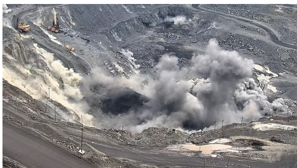
Рис.2. Формування пило-газової хмари після вибуху досліджуваного блоку №166 в період 08.09.2017р.
