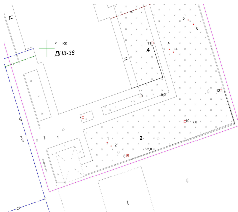
Рис. 1. Розташування реперів спостережної станції на території дитячого закладу
