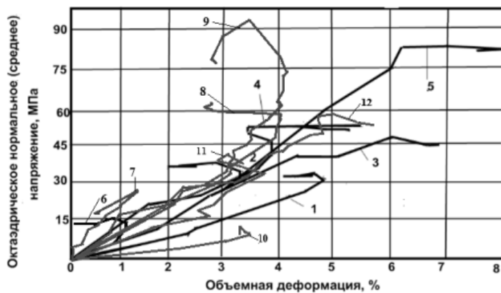
Рис. 1. Залежність «октаедричне нормальне напруження (кульовий тензор) – об'ємна деформація» (а) та «октаедричне дотичне напруження – октаедрична дотична деформація» (б) для аргіліту (1-6), пісковиків (7-9) і вугілля (10-12) при різних видах напруженого стану
