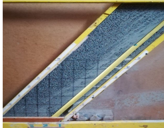
Рис.5. Стадії випуску похилого потоку першого шару відбитої руди із похилої щілини (камери) під прикриттям непорушеного рудного масиву: 1 – похила щілина; 2 – непорушений рудний масив
