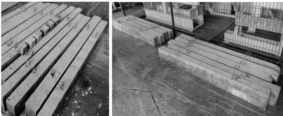
Рис. 6. Виготовлені зразки дослідних балок в лабораторії випробування будівельних конструкцій Криворізького національного університету
