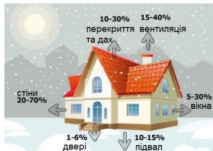
Рис. 1. Структура теплових втрат для типової будівлі
