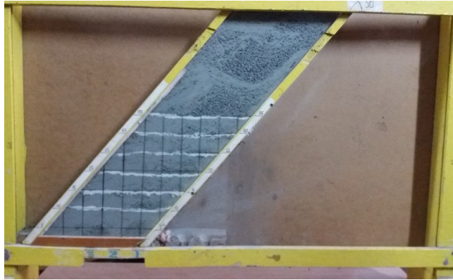
Рис.2. Лабораторна модель для дослідження випуску відбитої руди
