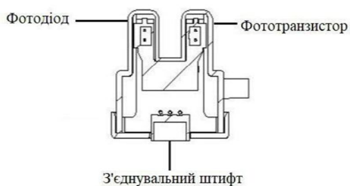
Рис. 1. Внутрішня складова датчика мутності
