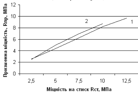
Рис. 6. Залежність бетонів між міцністю на стиск та призматичною міцністю: 1 – легкий керамзитобетон; 2 - легкий бетон на пористих заповнювачах-актипороритах із техногенної сировини
