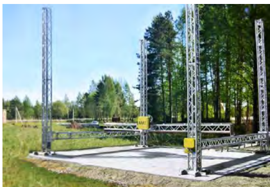
Рис.11. Будівельний 3D-принтер порталного типу "АМТ" S-300
