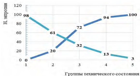
Рис. 11. Графическое представление определения предельных состояний в элементах копра для принятия решения
