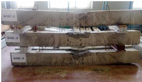
Рис. 5. Характер руйнування дослідних балок серії БМС-5 з гібридним армуванням 2\text{Æ}12 АКС800 і \text{Æ}12 А400С розтягнутої зони
