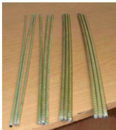
Рис. 2. Дослідні зразки склопластикової арматури АКС 800 \text{AE}8 , 10, 12 і 14 мм
