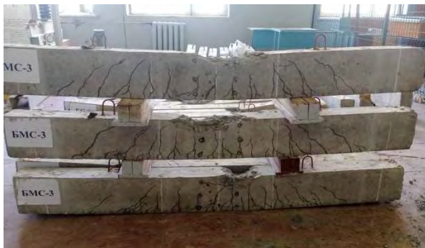
Рис. 3. Характер руйнування дослідних балок серії БМС-3 з гібридним армуванням 2\text{Æ}10 АКС800 і \text{Æ}12 А400С розтягнутої зони
