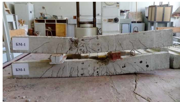
Рис. 4. Характер руйнування дослідних балок контрольної серії БМ-1 з металевим армуванням 3\text{Æ}12 А400С розтягнутої зони
