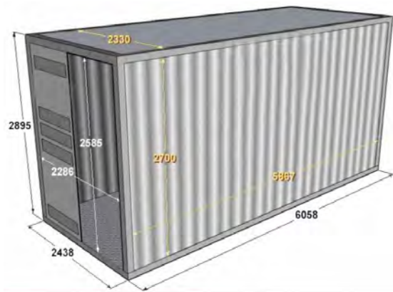
Рис.9. Розмірні параметри 20-футового морського контейнера
