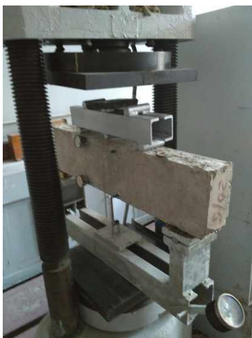
Рис. 3. Залізобетонна балка готова до випробувань
