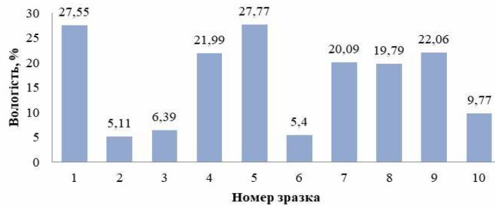
Рис. 3. Вологість досліджуваних зразків бурового шламу
