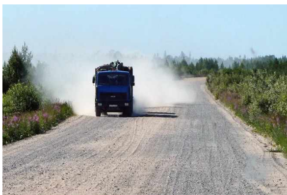
Рис.4. Винос пилу під час руху автомобіля
