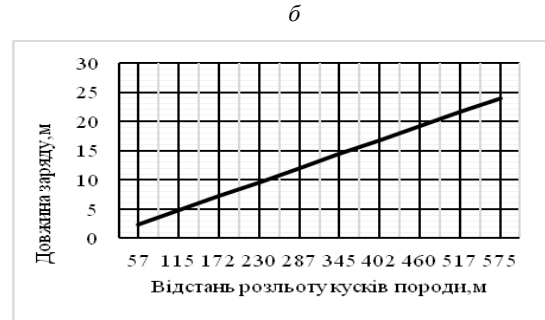
Рис. 2. Графік для визначення відстаней розльоту кусків гірської породи від довжини заряду в свердловині l_2 для: a - f=14, a = (6 \times 6) м; б - f=7, a = (7 \times 7) м
