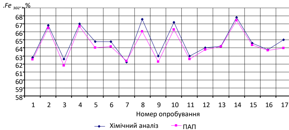
Рис. 5. Графік порівняльних значень опробування концентрату на РЗФ-2 Гірничого департаменту ПАТ «АрселорМіттал Кривий Ріг» поршковим аналізатором проб та хімічного аналізу за 01.07.2019 р., зміна № 2, бригада № 1
