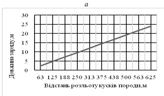
Рис. 2. Графік для визначення відстаней розльоту кусків гірської породи від довжини заряду в свердловині l_2 для: a - f=14, a = (6 \times 6) м; б - f=7, a = (7 \times 7) м
