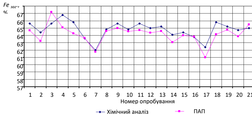
Рис. 4. Графік порівняльних значень опробування концентрату на РЗФ-1 Гірничого департаменту ПАТ «АрселорМіттал Кривий Ріг» порошковим аналізатором проб та хімічного аналізу за 12.04.2019 р., зміна № 1, бригада № 1
