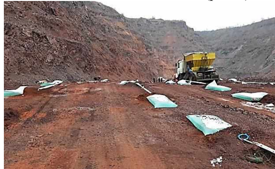
Рис. 3. Формування внутрішньої і зовнішньої гідро-забивки з розчину «DUSTRON™ EX 17» у блоці №71
