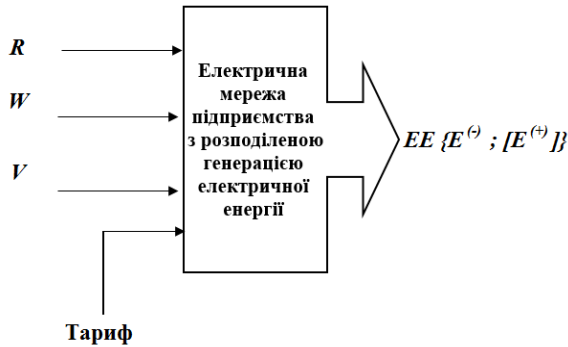
Рис. 1. Структура керування процесом електропостачання-електроспоживання підприємства з підземним видобутком залізорудної сировини ( R - видобуток руди; W - витрати води при водовідведенні; V - витрати повітря в режимі вентиляції; E^{(+)} - генерація ЕЕ, E^{(-)} - витрати ЕЕ)
