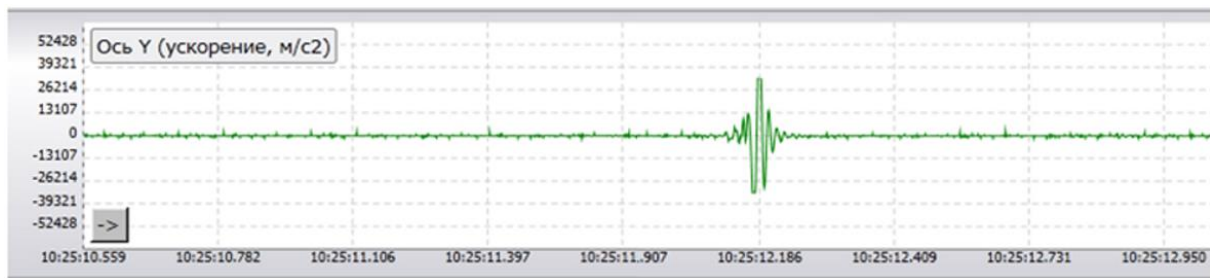
Рис. 3. Сигнал тріщини на відстані 25м. A_y = 28214 од.ащп, T = 48 мс
