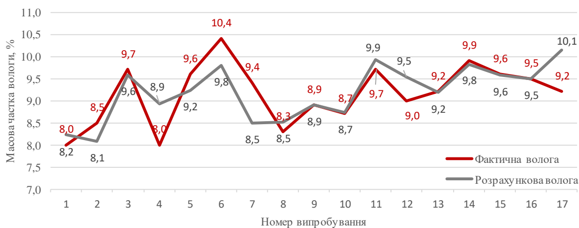
Рис. 1. Результати перевірки адекватності математичної моделі, яка характеризує зміння залишкової вологи у концентраті від параметрів роботи керамічного фільтру
