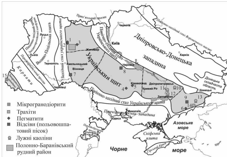
Рис. 2. Схема родовищ та площ розвитку польово-шпатової сировини в Україні: Родовища пегматитів: 1 - Більчаківське, 2 - село Устя; 3 - Грузлівецьке; 4 - Лозуватське; 5 - Володимирівське, 6 - Балка Великого табору; кристалічних порід: 14 - трахіти ділянки Вербова, мікрогранодіорити Дубриньцького родовища, лужні каоліни; 10 - Просянівське; 11 - Першозванівське; 12 - Біляївське; 13 - Катеринівське: супутні корисні копалини (відсів - польовошпатово сировина): 7 - Бахтин (флюоритові руди); 8 - Носачівське (титан-ільменітові руди); 9 - Мазурівське (руди танталу і ніобію)
